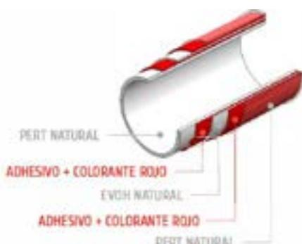
Las tuberías PERT EVOH de 5 capas tipo II, se pueden utilizar para la distribución de agua en sistemas de calefacción y/o refrigeración. Gracias a la gran flexibilidad de este material, las operaciones de colocación de los tubos resultan extremadamente sencillas, ya que no está sujeta a incrustaciones y fenómenos electroquímicos.
