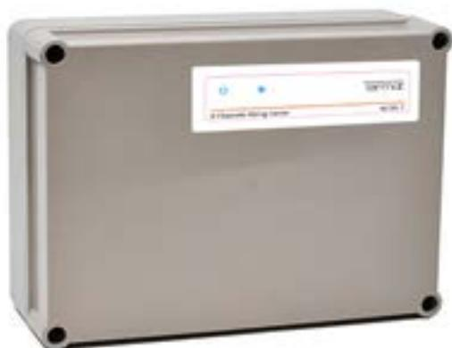
Es una unidad de conexión alimentada a 230 VCA o 24 VCA que permite conectar hasta 8 termostatos. Cada termostato corresponde a una zona independiente que se controla encendiendo o apagando los cabezales electro térmicos aplicados a los colectores de distribución. Si es necesario, ALC 01 activa la bomba secundaria o de caldera cuando hay demanda de calefacción de al menos una zona.
